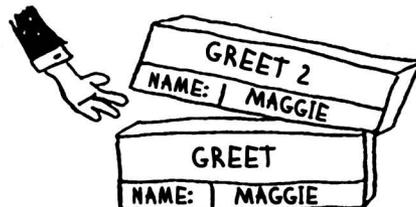
Теперь верхний блок в стеке относится к функции `greet`; это означает, что вы вернулись к функции `greet`. При вызове функции `greet2` функция `greet` еще *не была завершена*. Здесь-то и скрывается истинный смысл этого раздела: *когда вы вызываете функцию из другой функции, вызывающая функция*
